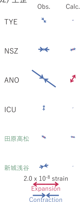
図4 2025/09/03PM-04の歪・傾斜変化（図2[B]）を説明する断層モデル。
