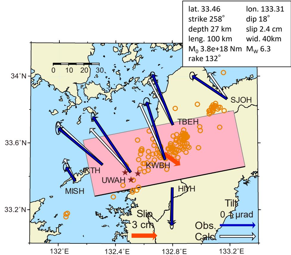
図2：6月10日～21日に観測された傾斜変化ベクトル（青矢印）、推定されたスロースリップイベントの断層モデル（赤矩形・矢印）、モデルから計算される傾斜変化ベクトル（白抜き矢印）を示す。1時間毎の微動エネルギーの重心位置（橙丸）、深部超低周波地震（茶星印）も合わせて示す。すべり角はプレート相対運動方向に固定している。
