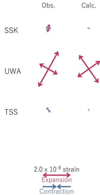
図4 2025/06/15の歪・傾斜変化 (図2[B]) を説明する断層モデル。
