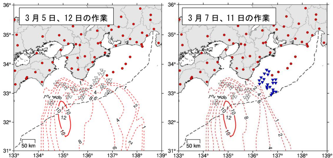
DONET 観測点：▼は緊急地震速報に活用する観測点、▽は緊急地震速報への活用を停止する観測点を表す。●は気象庁の観測点を表す。
