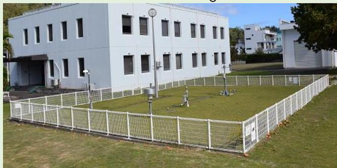
露場内の観測機器（温度・湿度計、雨量計、視程計）
