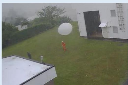
台風接近時の暴風雨の中 GPSゾンデを放球する職員
