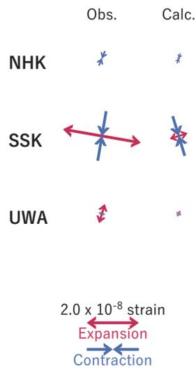
図9 2020/07/27PM - 30AM の歪・傾斜変化 (図6-8[A]) を説明する断層モデル。
