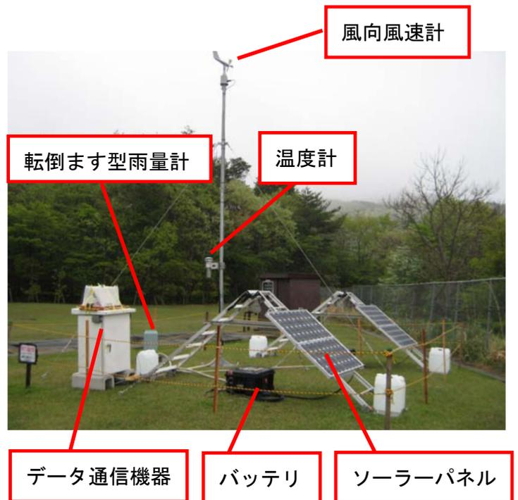
観測したデータを通信衛星によりリアルタイムで気象庁へ送信する。
