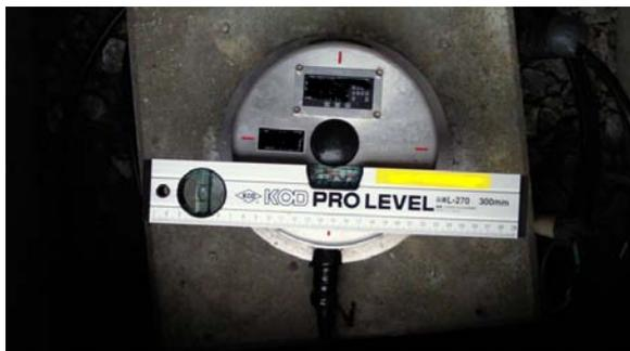
震度計台と地盤との間に隙間ができ、震度計台が西側（右方向）に傾いた。
