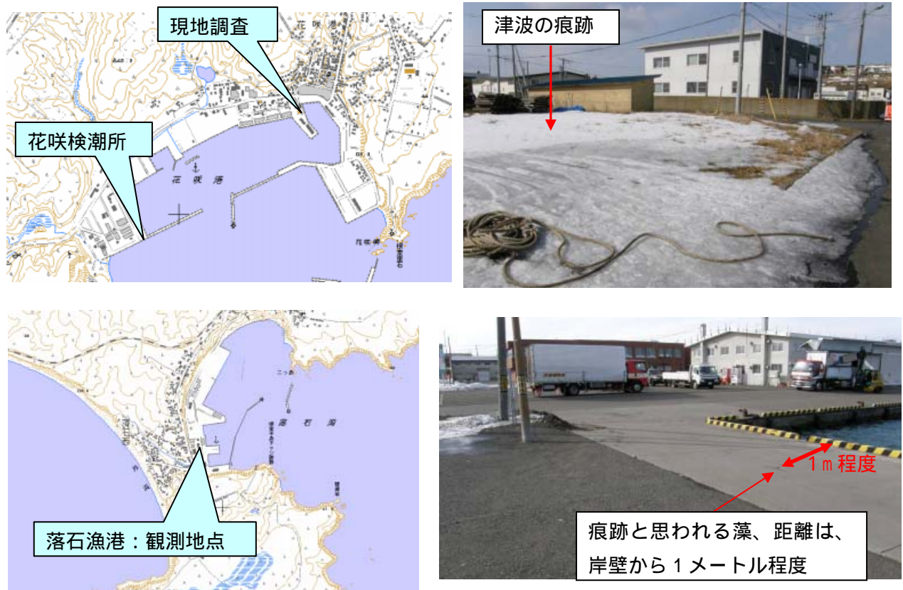
図 津波の高さを推定した地点の状況 (上図：花咲港、下図：落石漁港)
