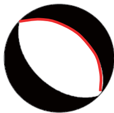
北東傾斜の断層を設定した場合 (走向 310°, 傾斜 42°, すべり角 -93°)
