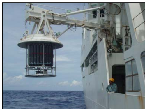
海面下 6,000 メートルまでの水温、塩分を観測し、海水を採取する装置
