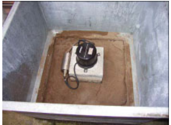
センサーおよび設置台(設置台が傾斜)
