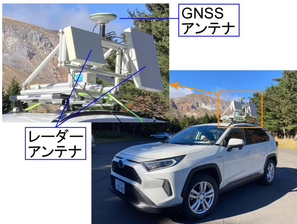
第1図. 次世代火山研究事業で開発している可搬型レーダー干渉計(SCOPE)の車載方式
