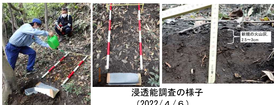
図 6 地上での浸透能調査の様子
