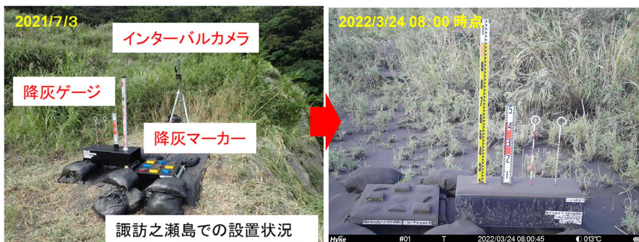
図 4 降灰ゲージ・降灰マーカーでの監視状況
