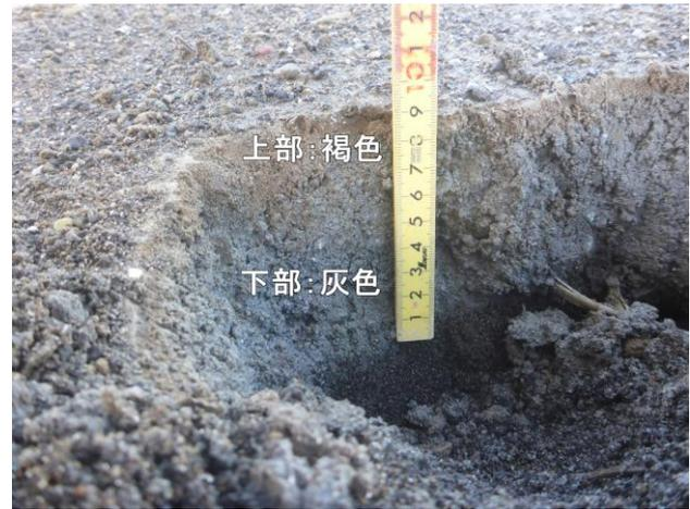
図 32 噴出孔 A 火口縁の南約 80m の噴出物断面(12月9日)。厚さは 9.4cm で、下部は灰色、上部は褐色の堆積物からなる。
