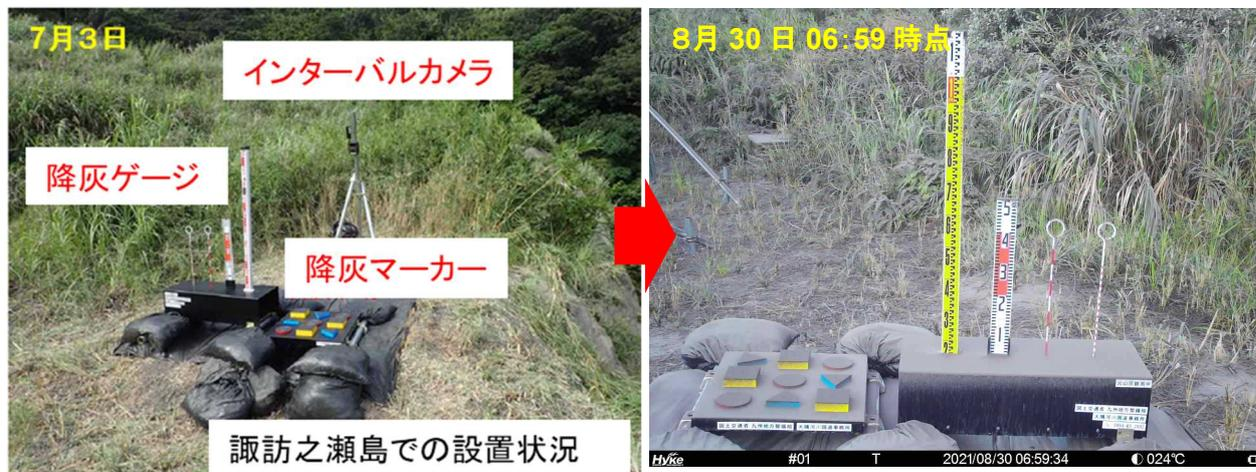
図 4 降灰ゲージ・降灰マーカーでの監視状況
