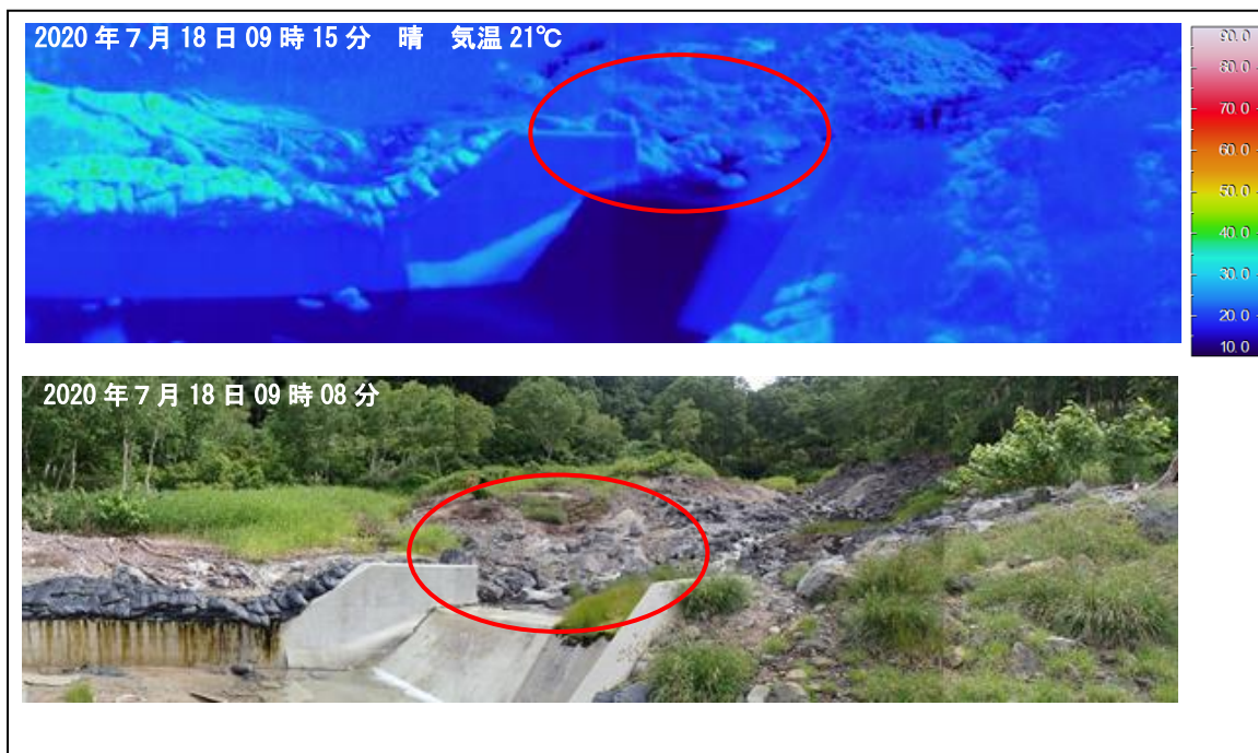
図 8 八甲田山 南西方向から撮影した地獄沼東の地熱域の状況と地表面温度分布
