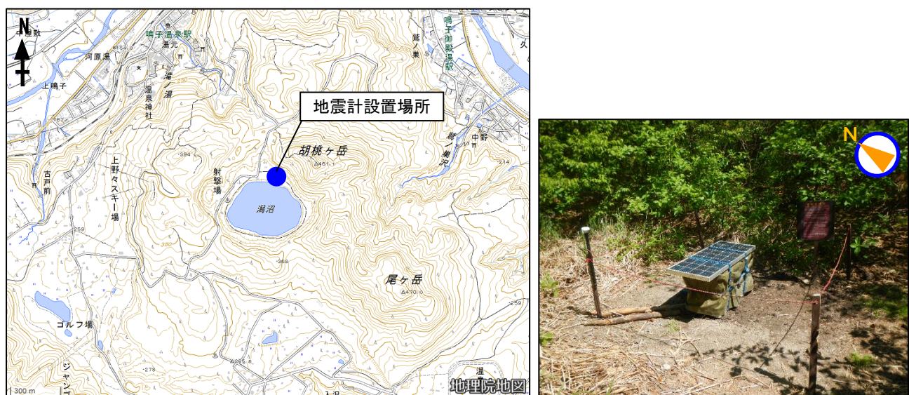
図 3 鳴子 現地調査で設置した地震計配置図と設置状況（南西方向から撮影）
