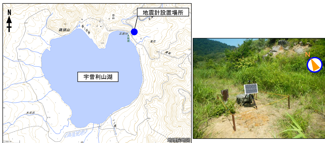
図3 恐山 現地調査で設置した地震計配置図と設置状況（南南西方向から撮影）
