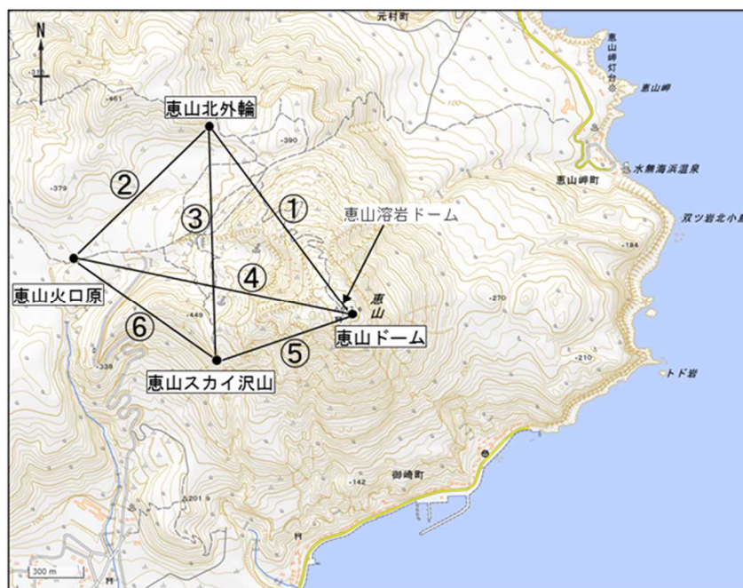
図 10 恵山 GNSS 繰り返し観測による基線長変化及び観測点配置図 (2005 年 8 月～2019 年 11 月)
