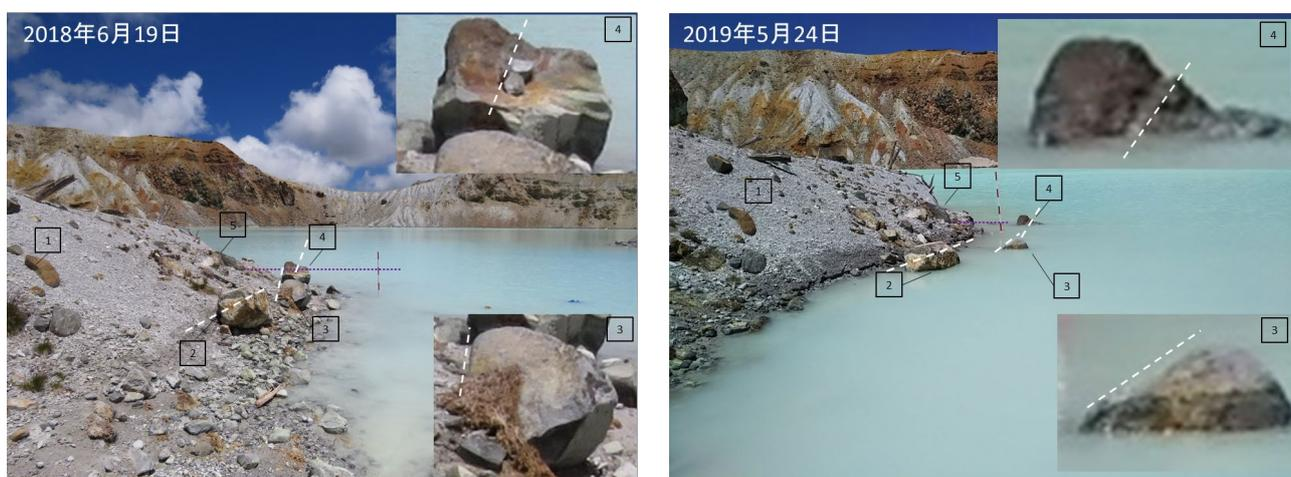
図1. 湯釜南岸の測量ポール設置場所付近での比較。岩「5」は、水面から十分高い位置にあり、周辺岩石との位置関係も明らかな変化がないので、移動していないと考える。2018年ポールと2019年ポールの位置は異なるが、岩「3」「4」の間に設置している。ポールは既に流出しているので厳密な比較はできないので、岩5とポールの相対位置に基づき水位上昇量を見積る。岩「5」からみて、2018年6月の水面は-80cm、一方で2019年の水面は-20cmと見積もった。あまり厳密ではないが、ポールの白赤(20cm)程度の信頼性はあるとみて、2018年6月19日と2019年5月24日の水位差は60cm±20cm程度で増加したものと推定した。
