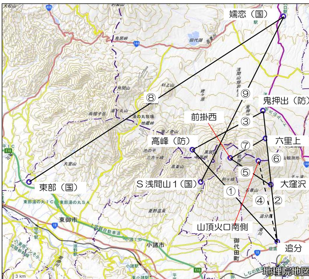
図10 浅間山 地殻変動連続観測点配置図
