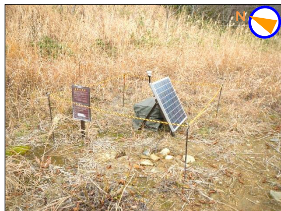
図8 恐山 現地調査で設置した地震計配置図と設置状況(西南西方向から撮影)
