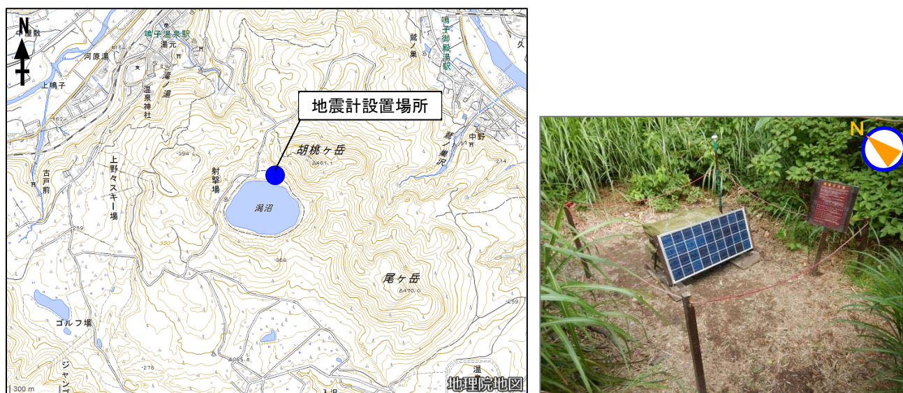
図5 鳴子 現地調査で設置した地震計配置図と設置状況（南西方向から撮影）
