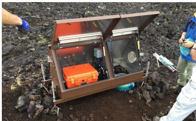
図 2. 設置した筐体とその内部に配したチャンバー部(右側)と計測・制御ボックス(左側オレンジ色)。
