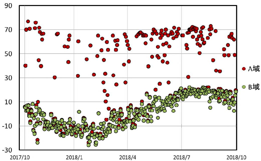
図 4 御嶽山 剣ヶ峰山頂の南西側の火口列の赤外熱映像カメラによる地熱域 ( A 域 ) と地熱兆候のない領域 ( B 域 ) の日最高温度の推移 ( 2017 年 10 月 10 日 ~ 2018 年 9 月 30 日 )
