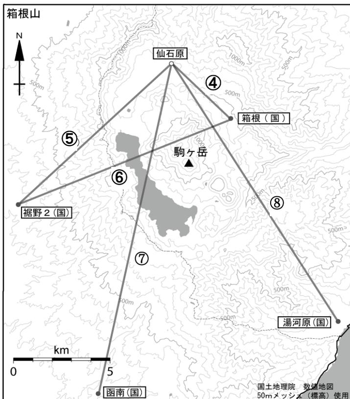
図7 箱根山 GNSS連続観測点配置図
