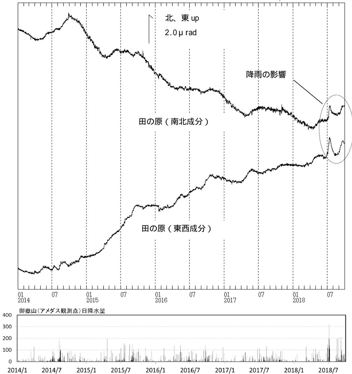
図 11 御嶽山 田の原観測点の傾斜変動 ( 剣ヶ峰山頂の南東約 3 km )
