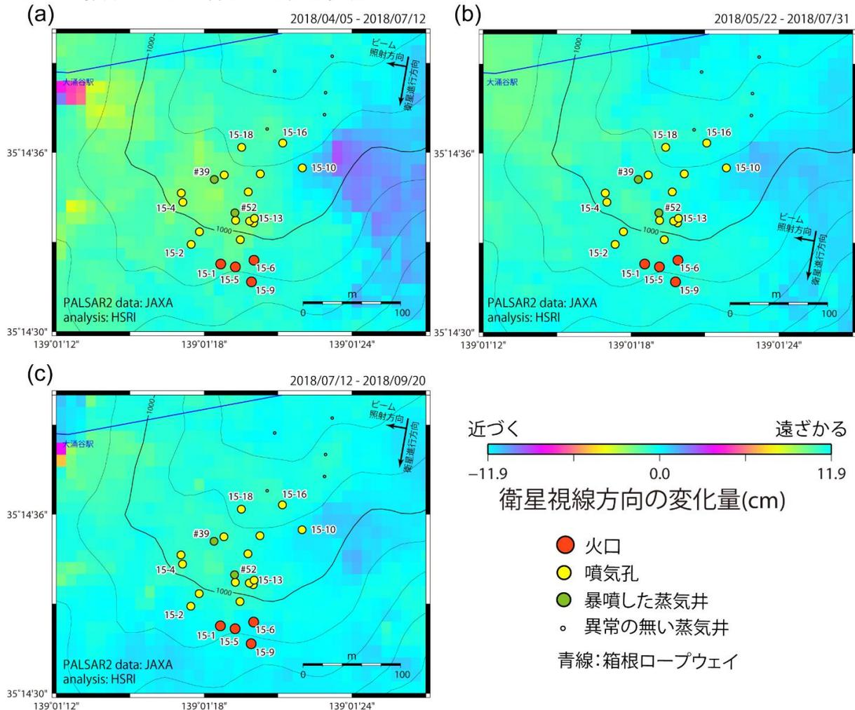
図 7 干渉 SAR 解析による大涌谷の地表面変位
