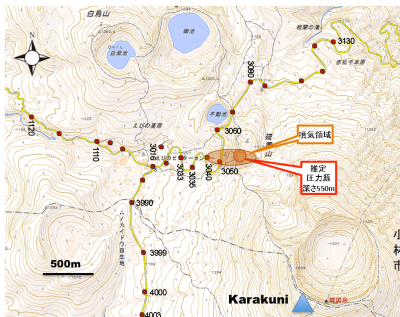
図 1 えびの高原～硫黄山区間の水準路線。2018 年 4 月から活発化した噴気領域や、これまでの水準測量から推定された圧力源の水平位置も同時に示す。国土地理院電子地形図(タイル)を使用した
