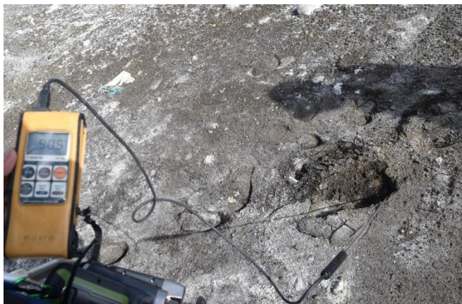
図 5 湾入部付近における砂層の温度測定. 地面から 20cm 深の温度をサーミスタ温度計 (佐藤計量器製作所 SK-1250MCIIIα) により測定.
