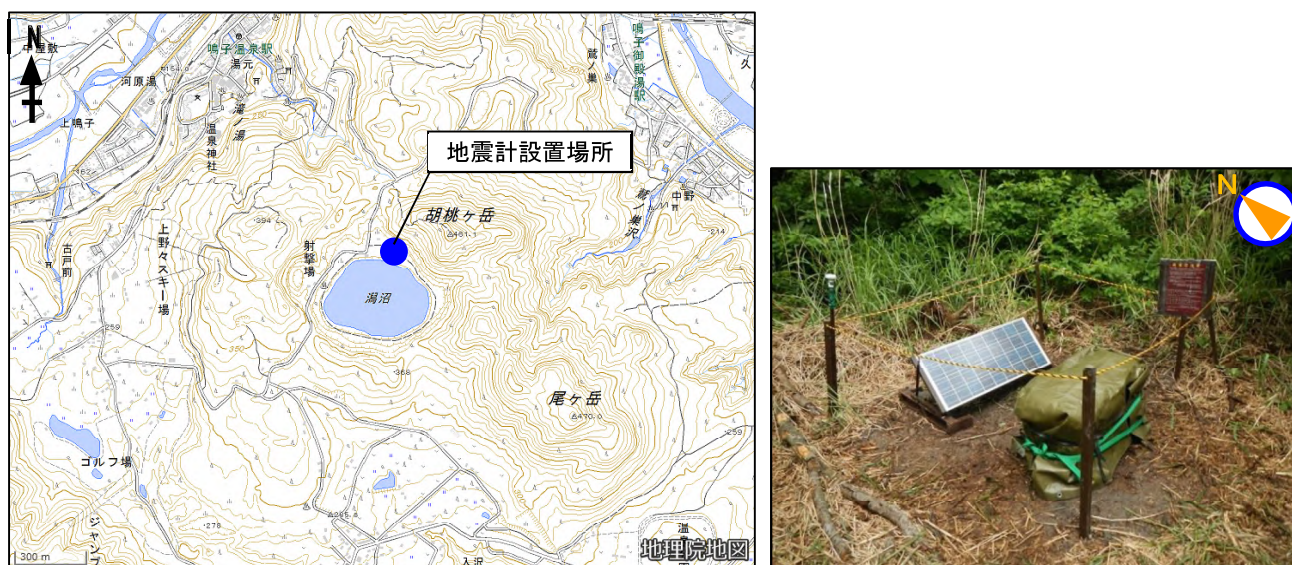
図7 鳴子 現地調査で設置した地震計配置図と設置状況 (南西方向から撮影)
