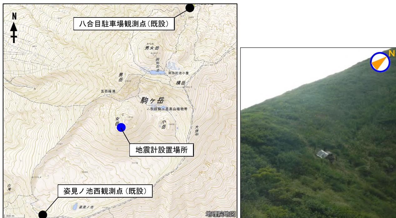
図 16 秋田駒ヶ岳 現地調査で設置した地震計及び既設観測点配置図と設置状況(南東方向から撮影) ・ 2017 年 8 月 3 日～10 月 18 日の期間で、データ収録型地震計(短周期速度)により観測を実施した。
