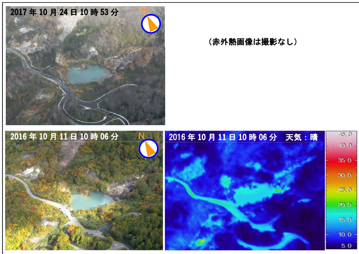
図 3 八甲田山 南南西方向の上空から撮影した地獄沼周辺の状況と地表面温度分布
