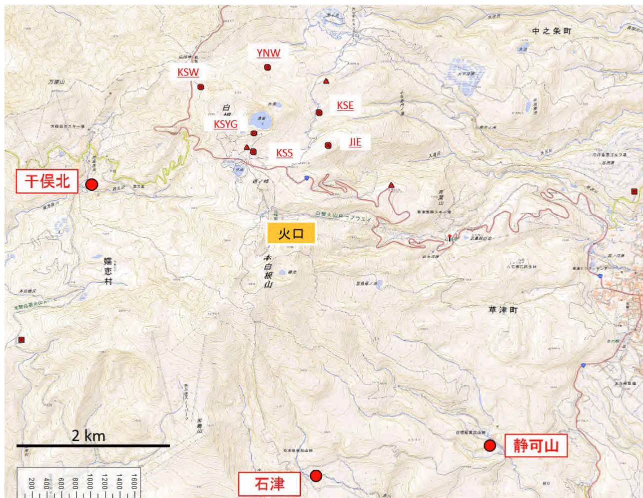
図4. 東工大が運用してきた湯釜火口湖周辺の定常地震観測点6点と、今回新たに設置した臨時地震観測点（静可山、石津、干侯北）の位置。地震計は広帯域地震計（Nanometrics 製 Trillium Compact 120 s, 東北大学所有）。作図には国土地理院地形図を使用した。
