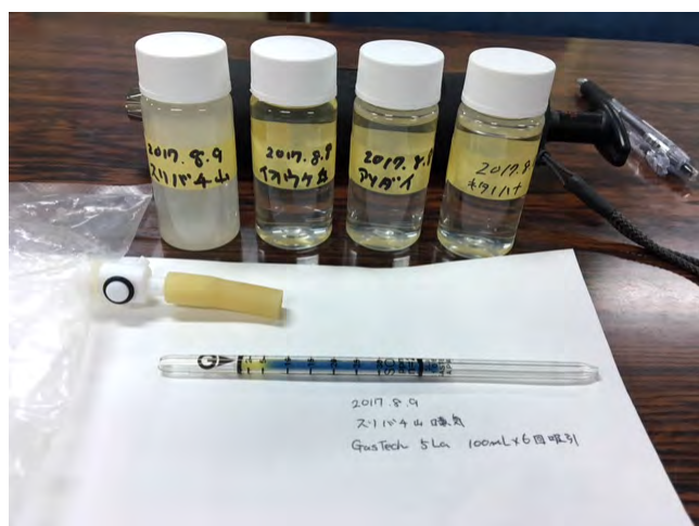
図 6. 4 地点で採取した火山ガスの凝縮水と摺鉢山の火山ガスの \text{SO}_2 分析後の検知管：
