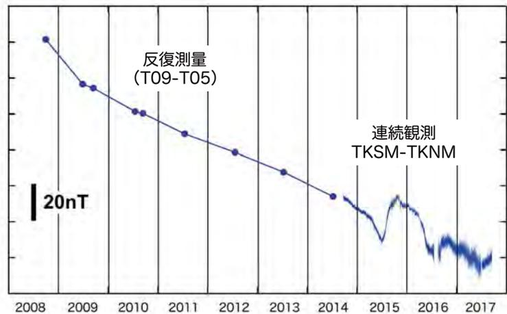
図 2 2008 年 9 月から 2017 年 9 月の全磁力変化 (2 地点の単純差プロット). 2014 年 9 月以前のデータは反復測量によるもの. T09 及び T05 は、それぞれ TKSM 及び TKNM 近傍の反復磁気点.
