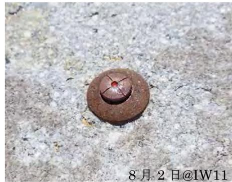
図 2 ステンレスピンの変化。左側は 2017 年 6 月 4 日の IW10 の写真。右側は 2017 年 8 月 2 日の IW11 の写真。IW11 では表面に錆が生じている。
