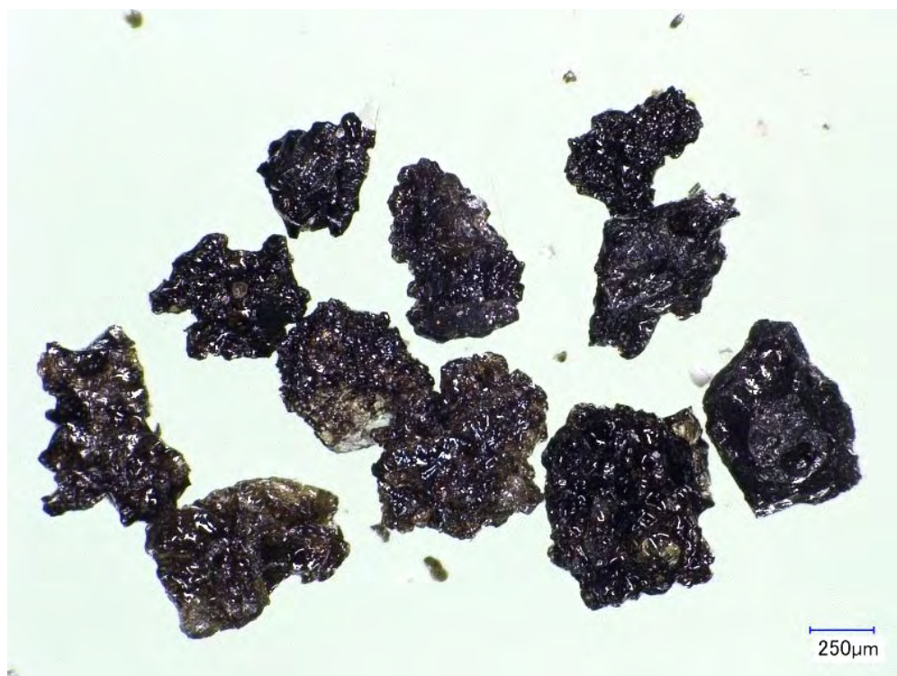
図3 発泡した濃褐色～黒色ガラス質粒子. 500–335 \mu\text{m} の粒子群に含まれるもの.
