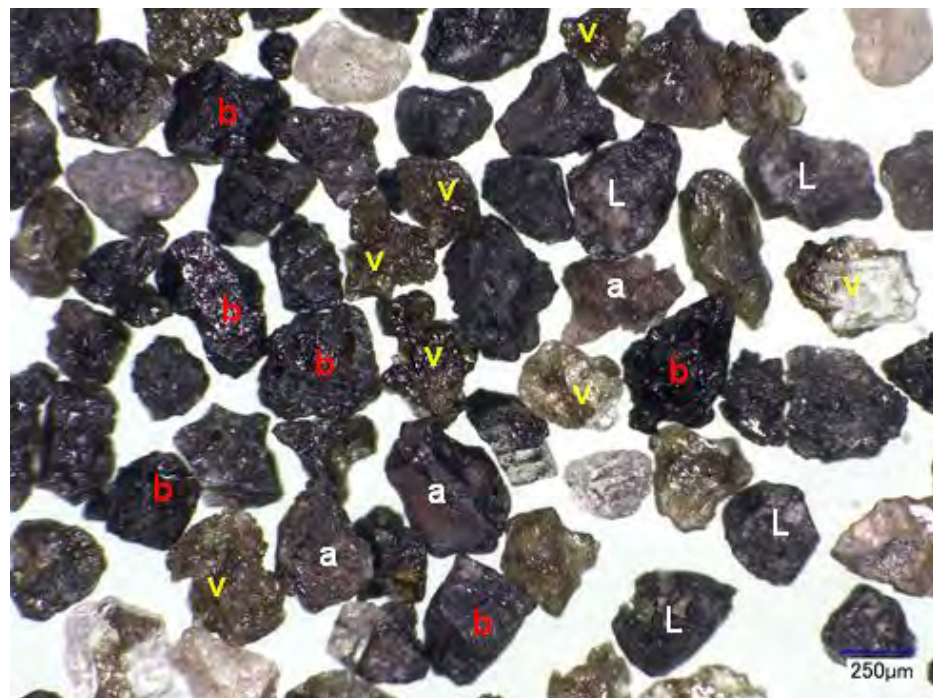
図2 昭和火口 2017 年 8 月 16 日昭和火口噴出物の構成粒子。335-250 \mu\text{m} の粒子群。代表的な粒子の区分を示す。V: 発泡したガラス光沢粒子, b: 黒色で鈍い光沢をもつブロック状の粒子, L: 溶岩片, a: 赤色酸化粒子。
