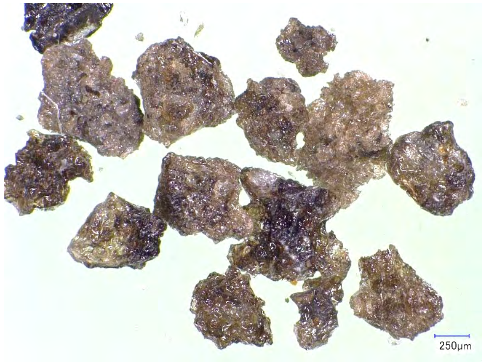
図2 発泡した淡褐色ガラス質粒子. 500–335 \mu\text{m} の粒子群に含まれるもの.
