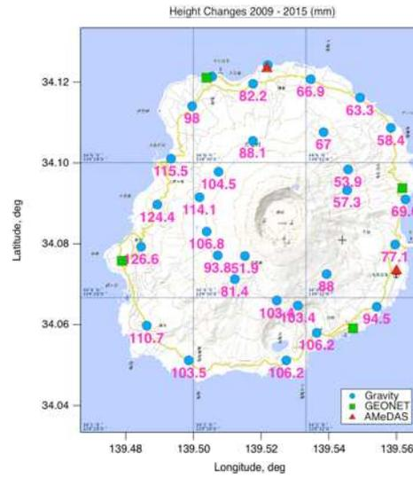
図2：2009年から2015年にかけての上下変動の推定値。単位は mm。GNSS 連続観測および水準測量のデータによる。
