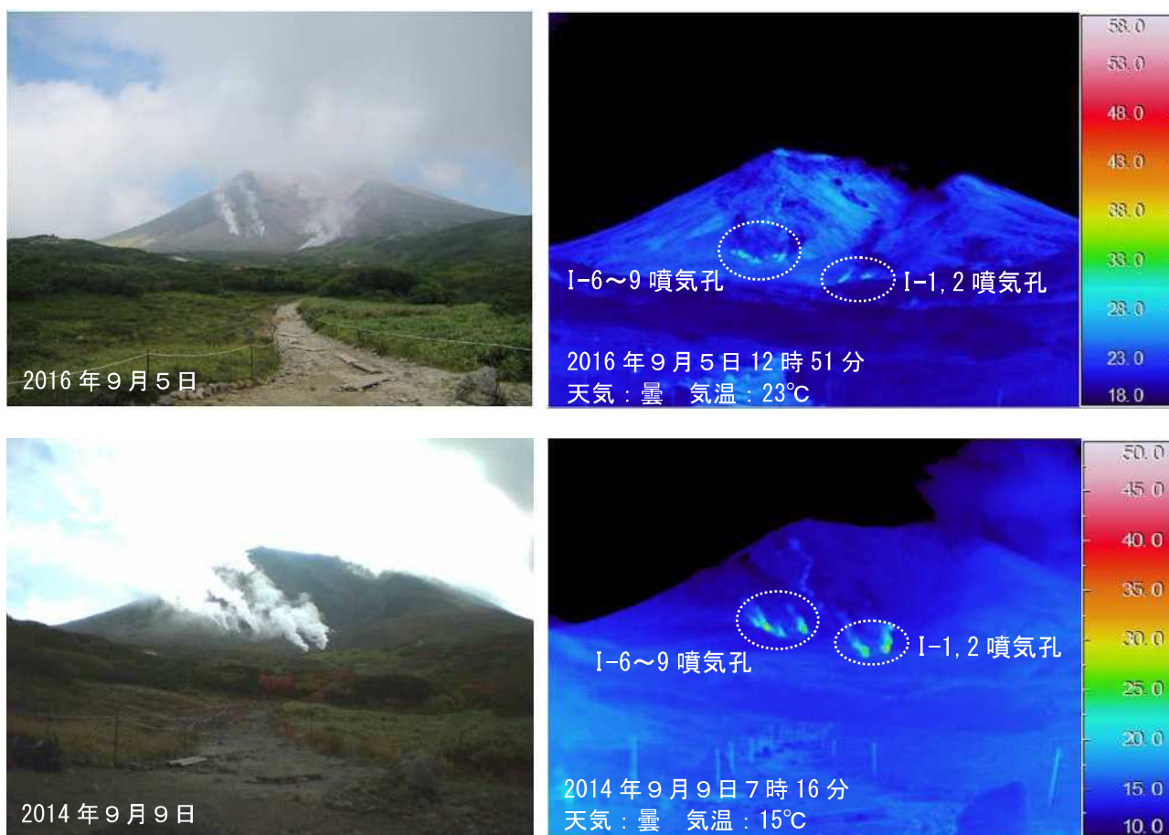
図 3 大雪山 赤外熱映像装置による旭岳地獄谷爆裂火口の地表面温度分布 西側 (図 2 中の①) から撮影
