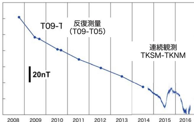
図 2 2008 年 9 月から 2016 年 9 月の全磁力変化 (2 地点の単純差プロット)。2014 年 9 月以前のデータは反復測量によるもの。T09 及び T05 は、それぞれ TKSM 及び TKNM 近傍の反復磁気点。
