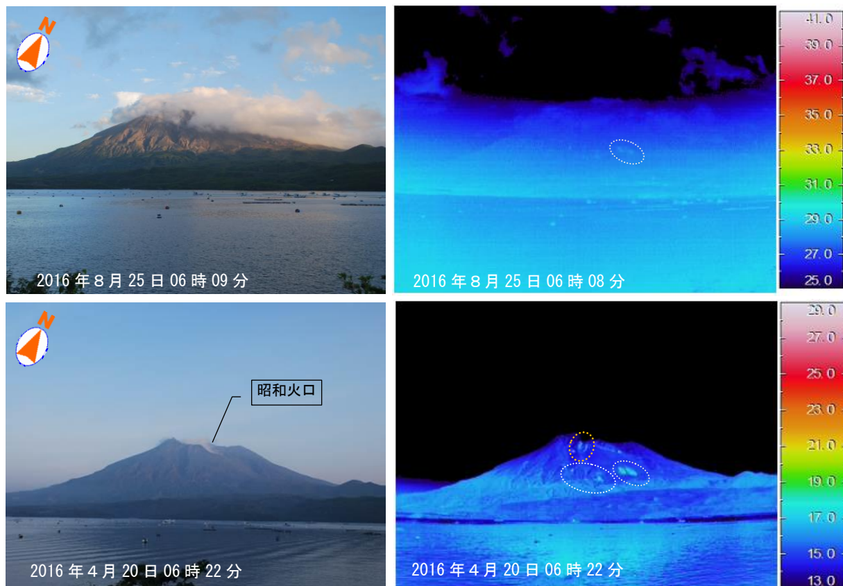
図 10 桜島 海淵トンネル脇道からの可視画像及び赤外熱映像装置による地表面温度分布 南岳南東側山腹（白破線内）にこれまでと同様に熱異常域が観測された。雲や水蒸気の影響で熱異常域は明瞭ではないものの、これまでの観測と比べ大きな変化は認められなかった。
