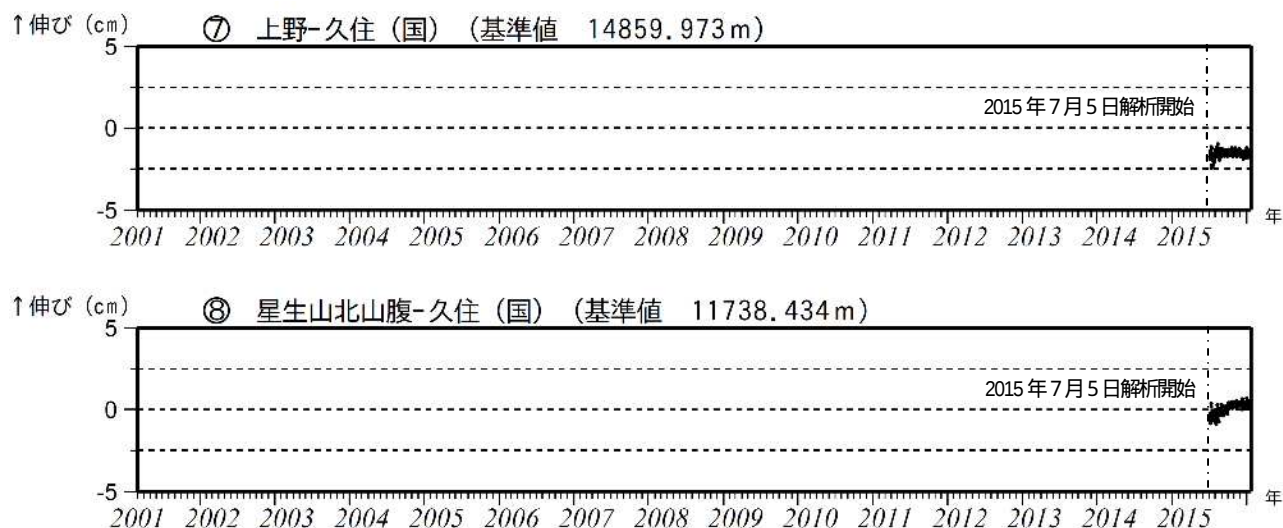
第 5-2 図 九重山 GNSS 連続観測による基線長変化 (2001 年 3 月 22 日～2016 年 1 月 22 日)
