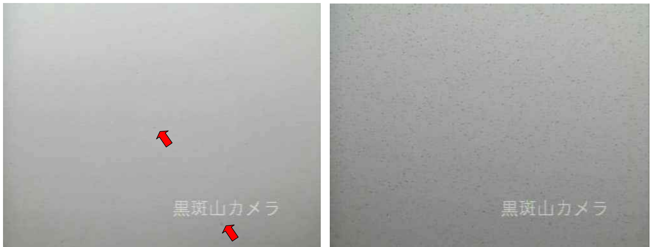
第5図 浅間山 6月19日の黒斑山監視カメラの画像（左・17時頃、右・17時30分頃） 17時頃に火山灰が付着しはじめる（左図赤矢印）。その後、画像全体に付着（右図）
