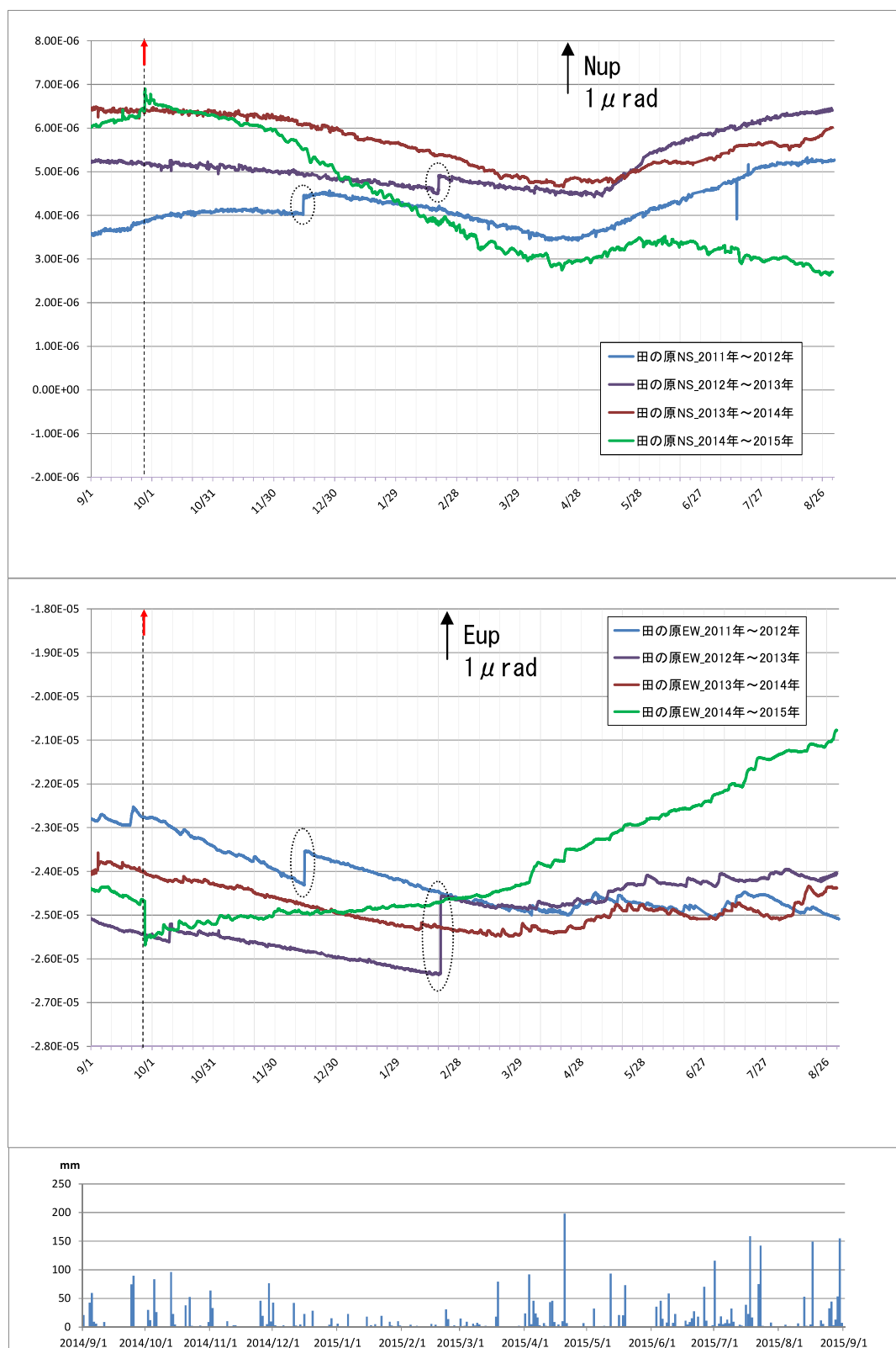
第 11-2 図 御嶽山 田の原（剣ヶ峰の南東約 3 km）の傾斜計の年周変動（過去 3 年）との比較 （2014 年 9 月 1 日～2015 年 8 月 31 日、時間値、潮汐補正済み、 上：NS 成分、中央：EW 成分、下：御嶽山アメダス降水量）
