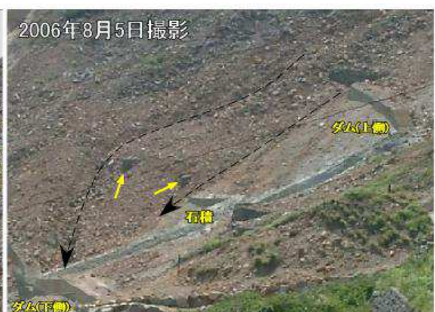
図10 15-1火口北西側の噴出物(噴石と火山灰)。噴出物は火口縁では最大で数メートル程度の厚さがあると推定されるが、外側に急速に薄くなり、以前からある岩(人工物?)のあたりでは数10cm以下になっている。火口縁の切れ目(もともとのガリー部分)から溢流した泥流跡が見える。
