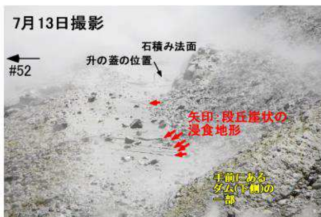
図9 15-1・15-5火口と52号井の間の温泉施設の巡視路に堆積した噴出物(火山灰層)。石積み法面そばの升の蓋は噴火後は噴出物に覆われて不明瞭になっている。路上の噴出物には流水で浸食され段丘崖状の微地形が生じている。以上からここでは最大で10～20cm程度の厚さがあると推定される。また、路上に転がる岩の一部は噴石である可能性がある。
