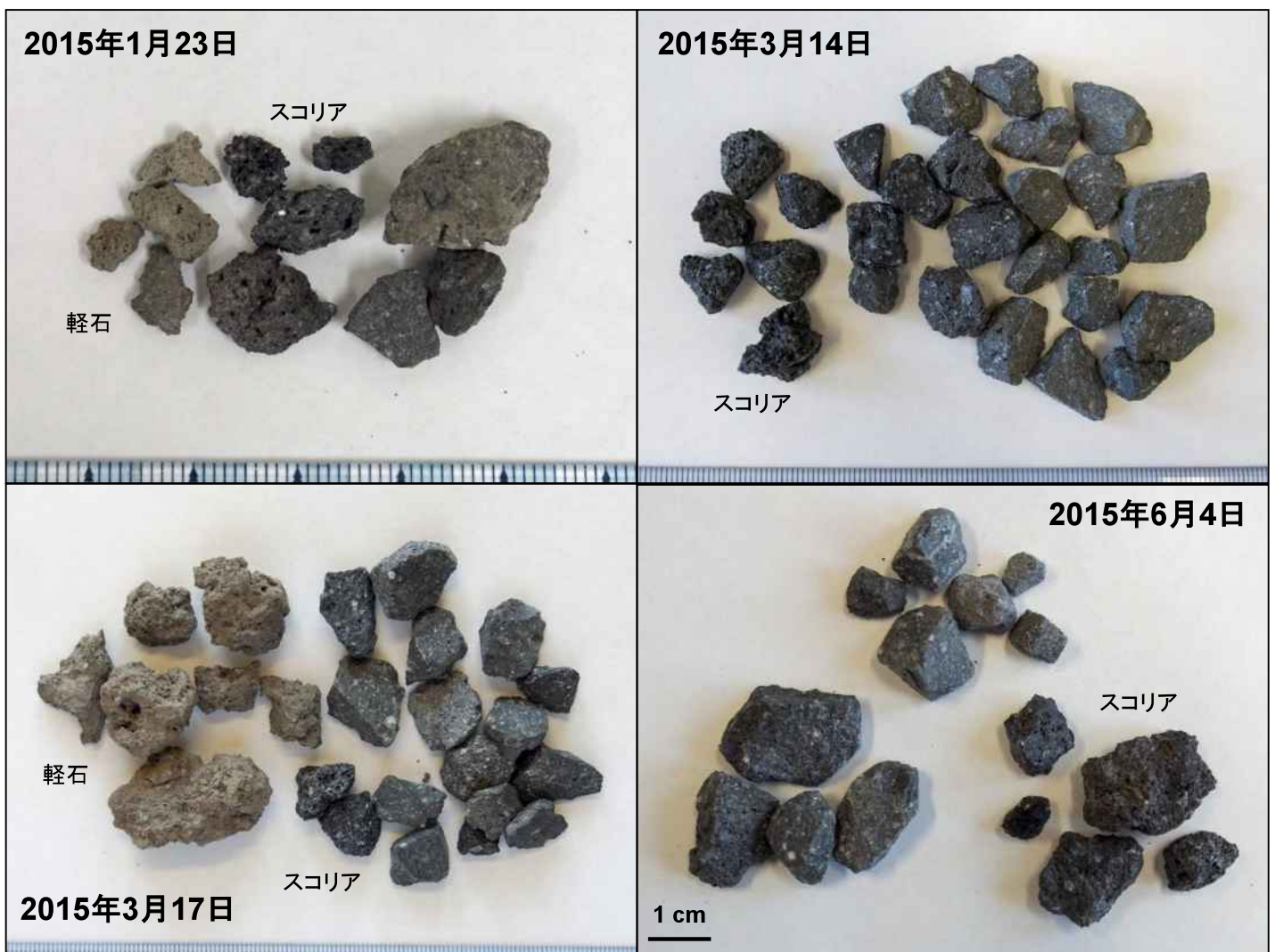
写真1. 噴出物の写真(メモリは1mm)。噴火規模が大きかった1月23日および3月17日噴出物中には軽石が認められる。
