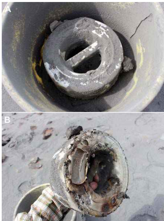
図 10 中岳第 1 火口南西側縁に設置した火山灰採取容器内のおもりの損傷状況（A が上面，B が下面の状況）
