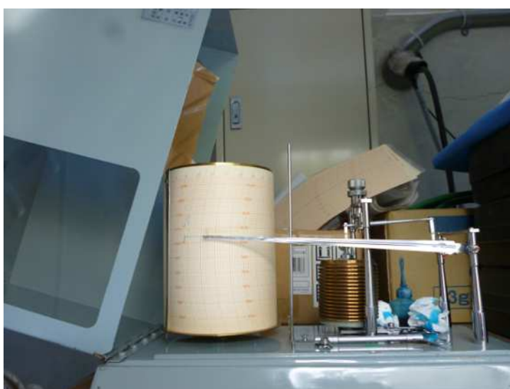
図 2.21 瀬戸観測点で比較観測に使用したアネロイド型自記気圧計
