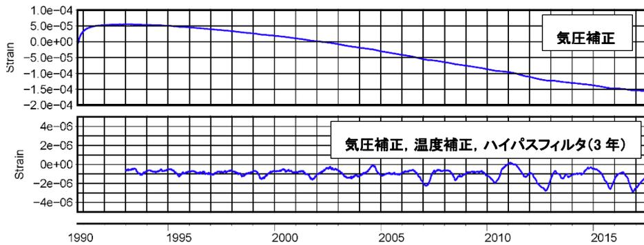
第 5 図 1990 年 10 月から 2017 年 9 月までの体積ひずみ変化. (上) 気圧補正のみ. (下) 短周期成分.
