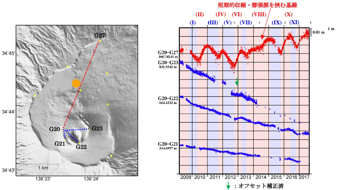
第12図 (左) 基線と短期的収縮・膨張源との位置関係。(●: 短期的収縮・膨張源)。(右) 三原山火口西(G20)を基準とした基線長変化(2009年3月1日から2017年8月26日まで)。
