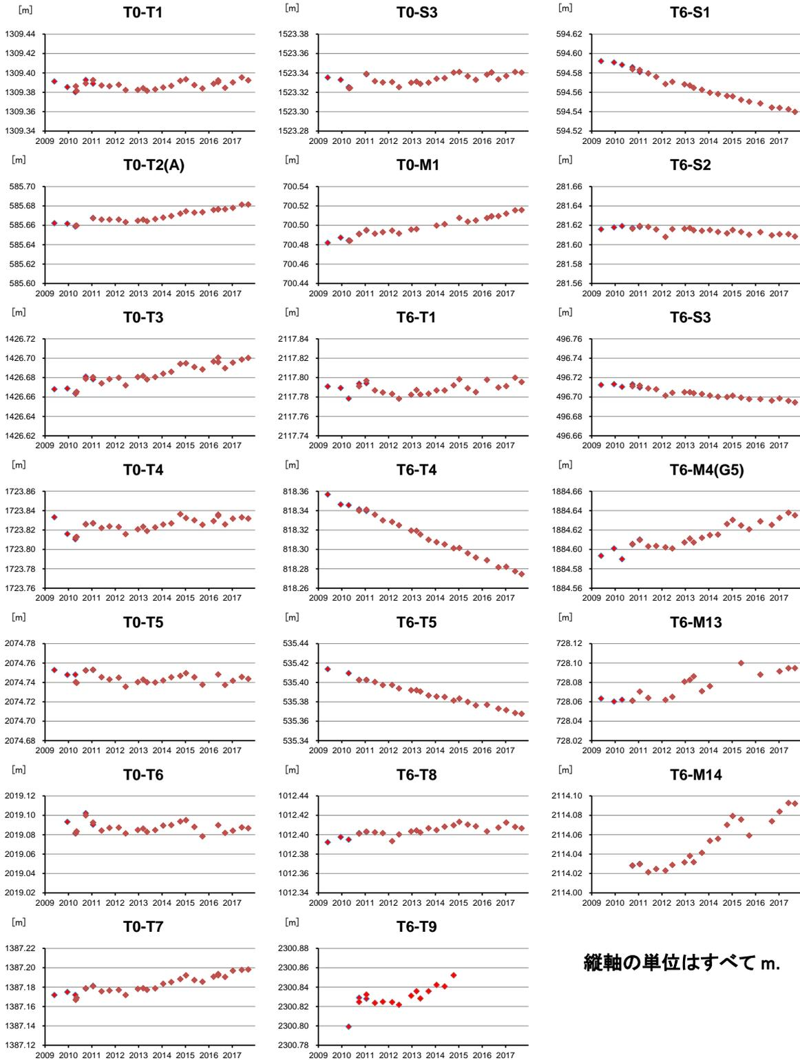
第 15 図 伊豆大島カルデラ内の EDM 繰返し観測網 (第 13 図 B) による斜距離変化 (2009 年 3 月～2017 年 9 月).
