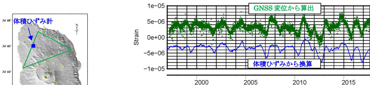
第 6 図 1997 年 1 月から 2017 年 9 月までの面積ひずみ短周期成分の経年変化. 青: 体積ひずみから換算した面積ひずみ. 緑: 左図三角形で示された 3 観測点の GNSS データから算出した面積ひずみ.
