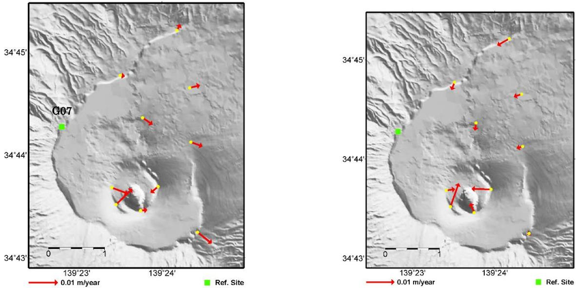
第10図 北西カルデラ縁 (G07) を基準とした三原山観測点の相対変位 (2014年8月27日から2017年8月26日まで). (右) 推定した変動源 (図12 (左) 参照) とその体積変化量 (図9参照) から求められる各点の水平変位を補正したもの. 火口付近の収縮が明瞭になっている.
