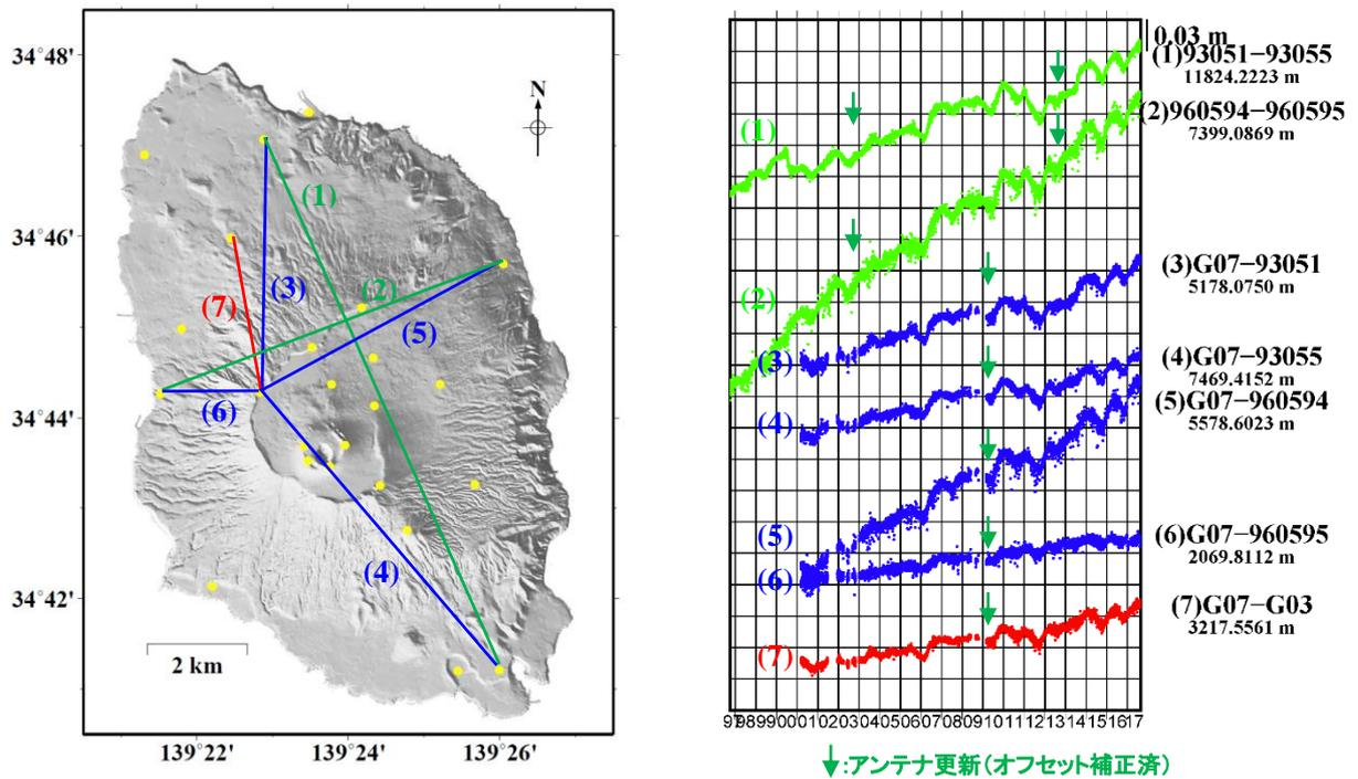
第2図 1997年10月1日から2017年8月26日までのGNSS基線長変化。
