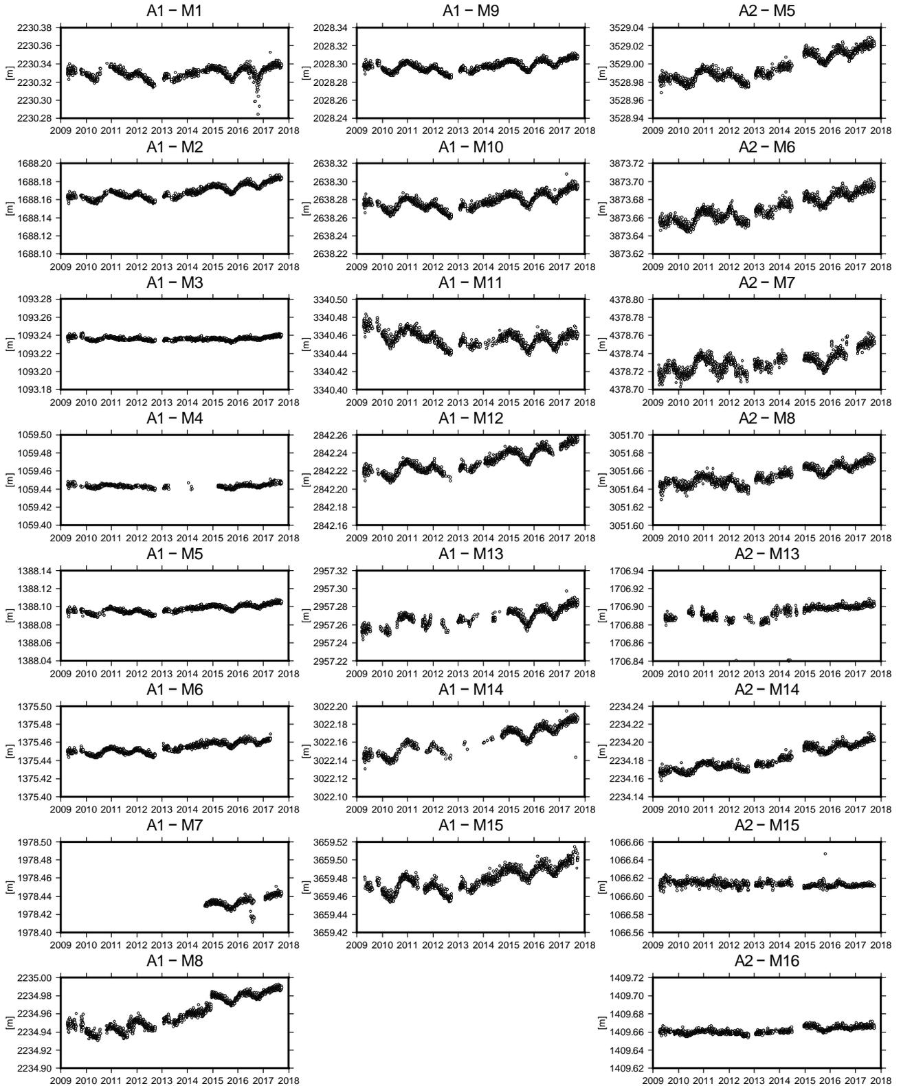
第 14 図 伊豆大島カルデラ内の EDM 連続観測網 (第 13 図 A) による斜距離変化 (2009 年 4 月 1 日 ~2017 年 9 月 25 日)。
