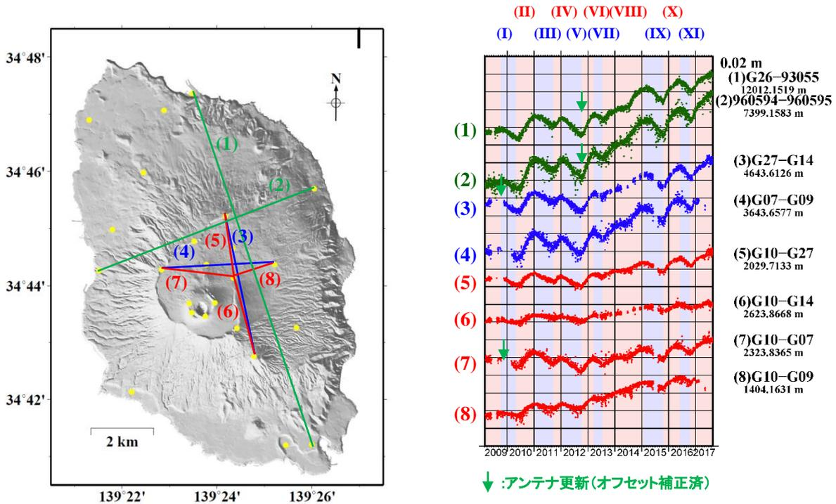
第 4 図 2009 年 3 月 1 日から 2017 年 8 月 26 日までの GNSS 基線長変化.
