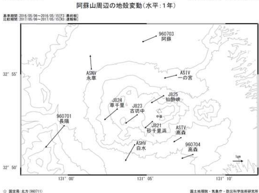
第3図 阿蘇山周辺の電子基準点・気象庁・防災科学技術研究所 GNSS 観測点の統合解析による水平変動ベクトル図 (上段: 2017年2月~2017年5月、下段: 2016年5月~2017年5月)
