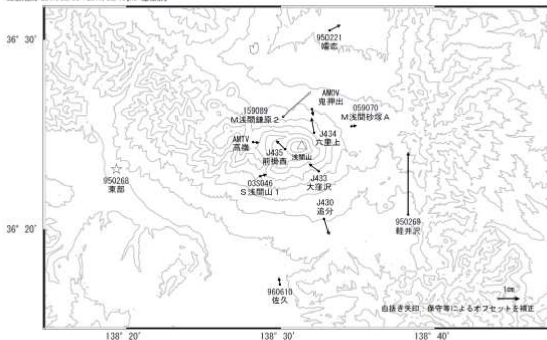
第3図 浅間山周辺の電子基準点・気象庁・防災科学技術研究所 GNSS 観測点の統合解析による水平変動ベクトル図 (上段:2017年2月~2017年5月、下段:2016年5月~2017年5月)
