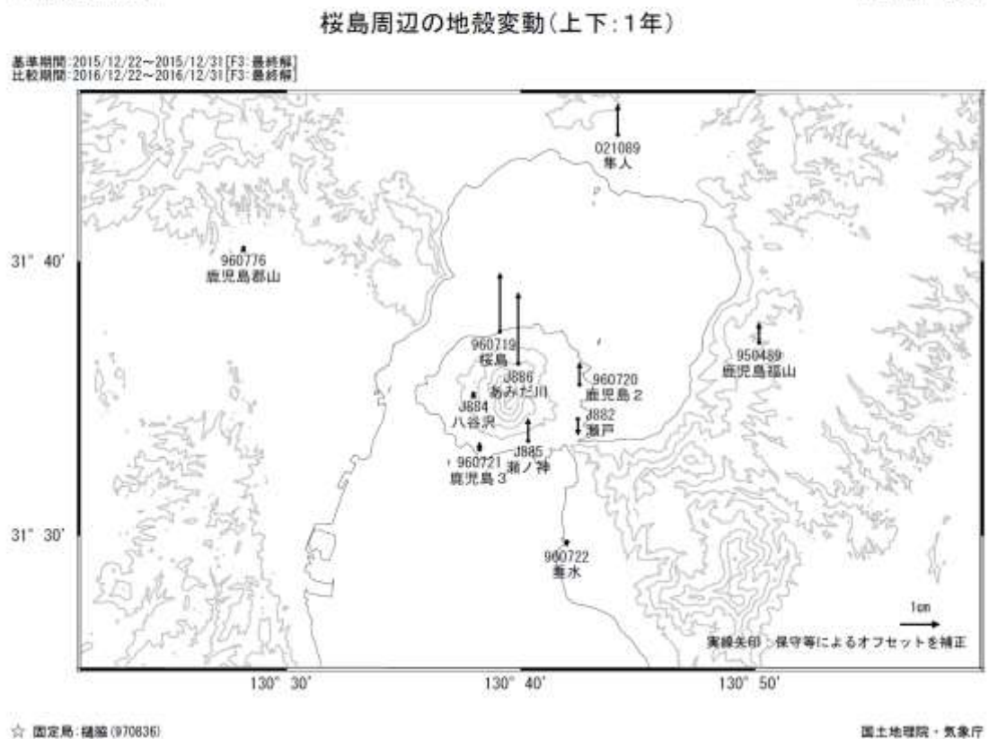
第 3-3 図 桜島周辺の電子基準点・気象庁 GNSS 観測点の統合解析による上下変動ベクトル図 (上段:2016 年 9 月~2016 年 12 月、下段:2015 年 12 月~2016 年 12 月)
