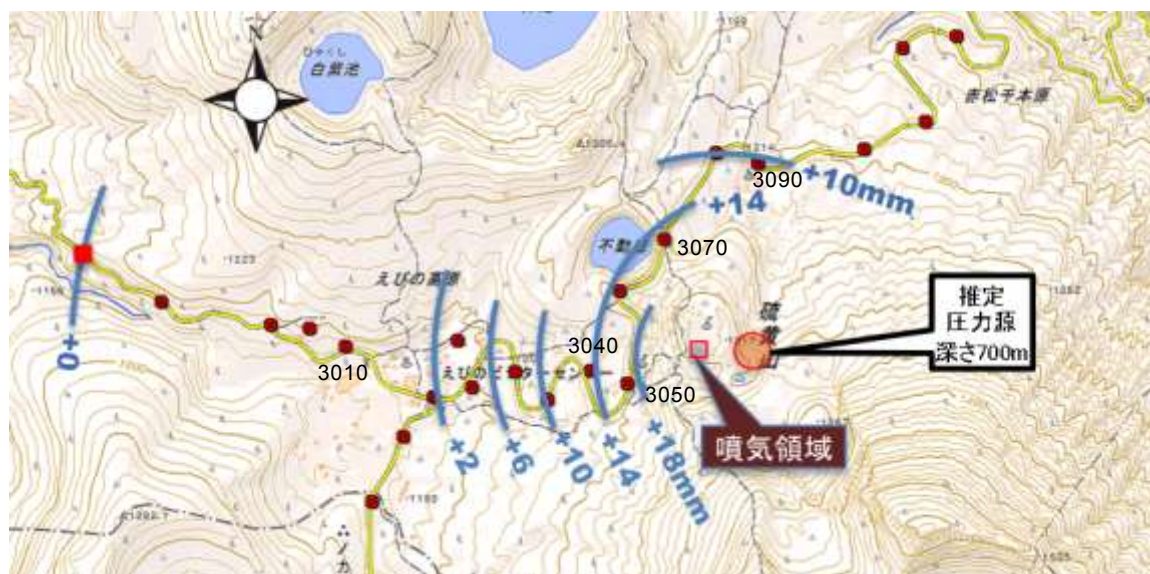
第 1 図 えびの高原周辺の水準測量路線と 2015 年 6 月～2016 年 11 月に観測されたの上下変化 (単位 mm)。
