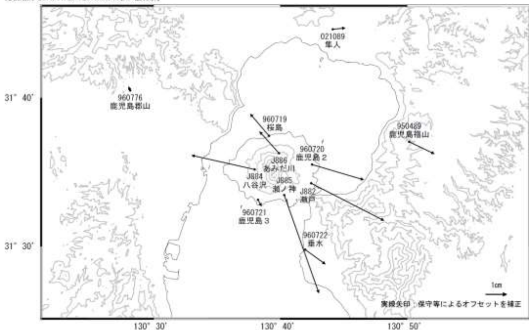
第4図 桜島周辺の電子基準点・気象庁 GNSS 観測点の統合解析による水平変動ベクトル図 (上段: 2016年4月~2016年7月、下段: 2015年7月~2016年7月)
