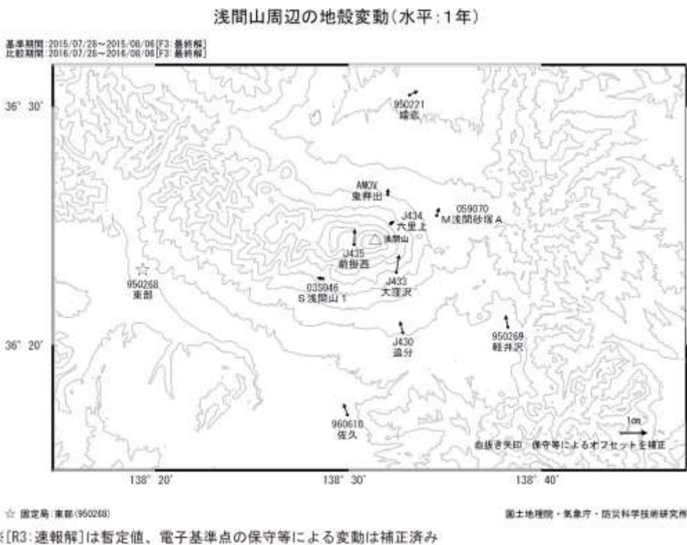
第3図 浅間山周辺における GNSS 連続観測結果 (上段: 基線変化グラフ 2015 年 8 月~2016 年 9 月、下段: 電子基準点・気象庁・防災科学技術研究所 GNSS 観測点の統合解析による水平変動ベクトル図 (2015 年 7 月~2016 年 7 月))
